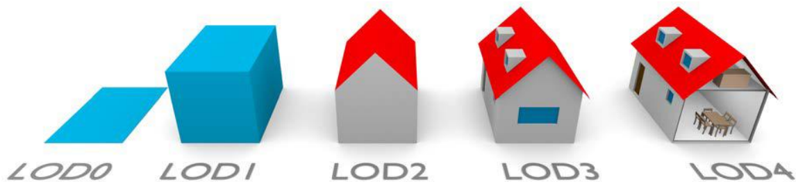
Figura 2.3 - Níveis de detalhe, fonte (Biljecki, Level of Detail in 3D City Models , 2017)
